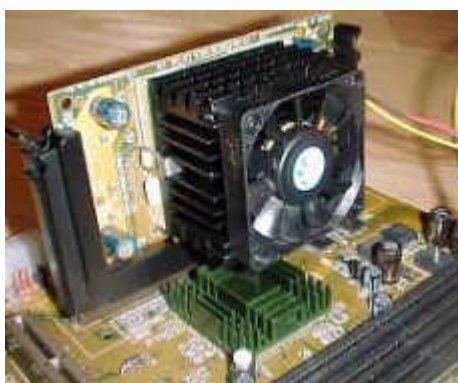
Celeron encaixado no adaptador
