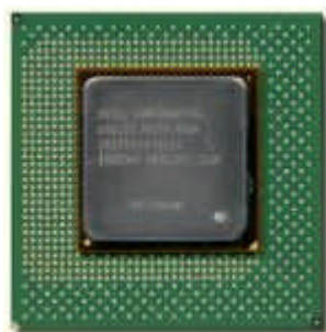
Pentium 4: a chapa metálica protege o chip
